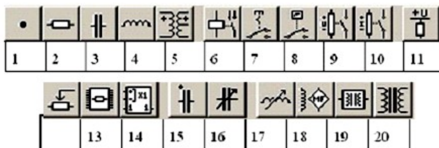
Рис.2.4. Библиотека Basic – пассивных элементов
