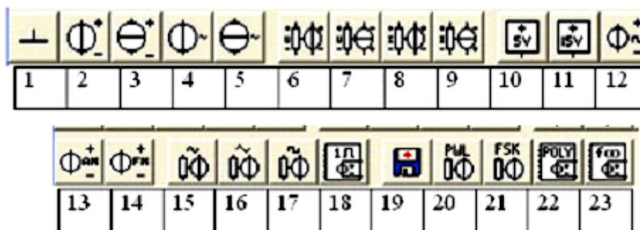
Рис.2.3 Библиотека Soures – источников тока и напряжения
