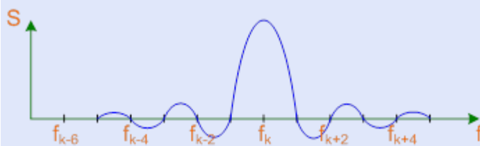
Рисунок 5.2 Огибающая спектра одной несущей с номером k при модуляции OFDM
