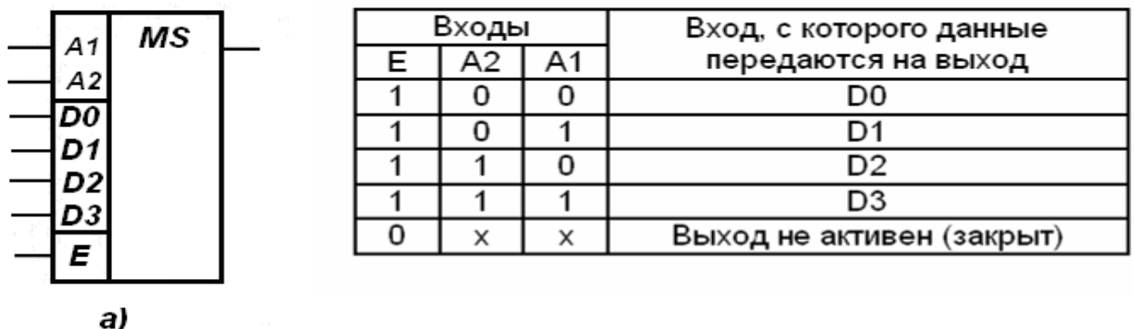
Рис.3.1. УГО (а) и таблица коммутации входов (б) мультиплексора
