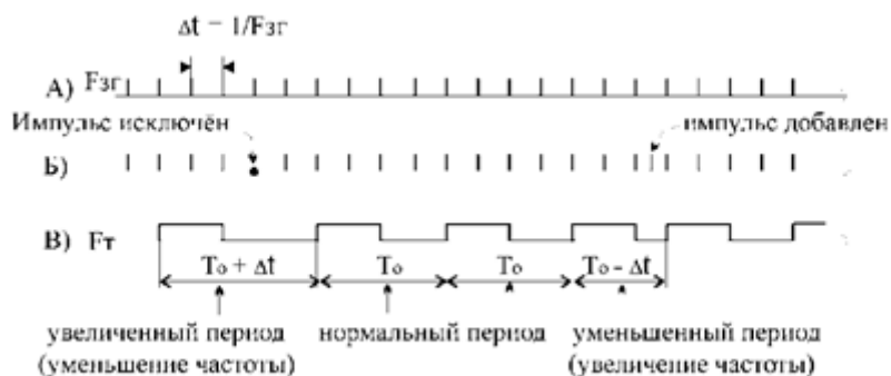
Рисунок 8.2 – Изменение частоты(фазы) при добавлении/исключении импульса (Кдел-4) А-выход местного генератора, Б- вход УДЧ, В- выход УДЧ
