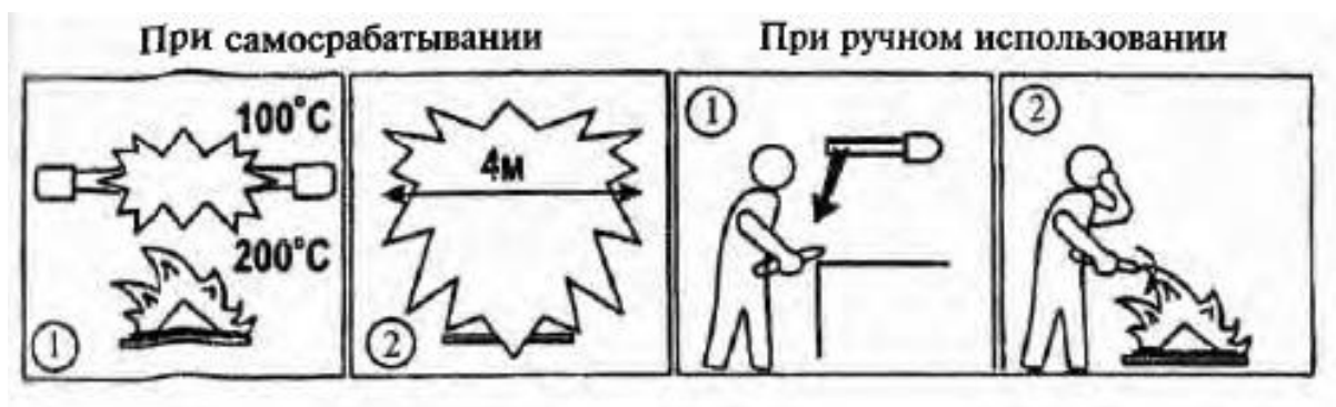
Рис. 1.10. Принцип работы ОСП
