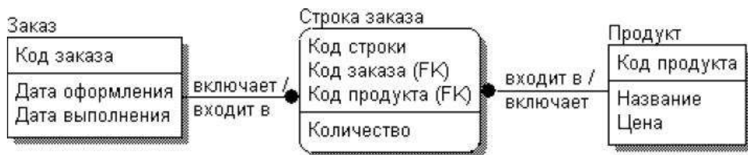
Рисунок 7.Пример логической схемы БД
